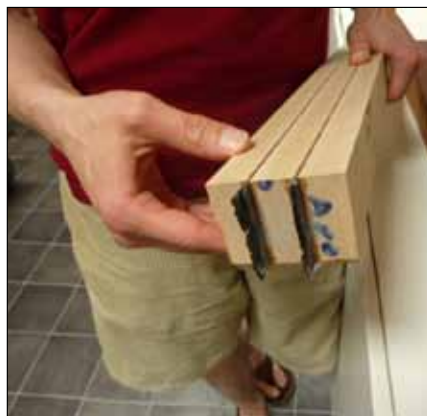
Detta ska bli genomgående halsar för två gitarrrer, en sjusträngad och en åttasträngad. Två grupper om dubbla kolfiberlaminat med dekorativ smal mahognyskiva emellan.
